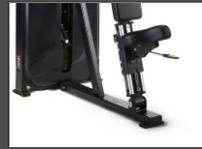
**Рычаг регулировки высоты**
